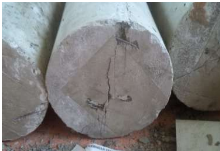
Cosido de Matriz de hormigón con fibra de acero
