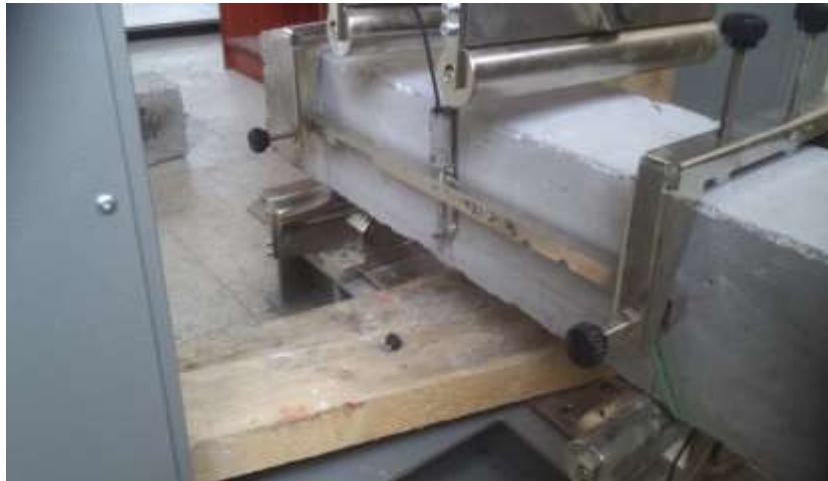
Gráfico # 14: Colocación de transductores de desplazamiento
