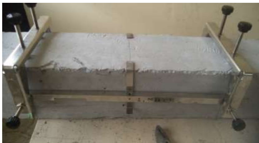
Gráfico # 13: Colocación de accesorios para ensayo a flexión.
