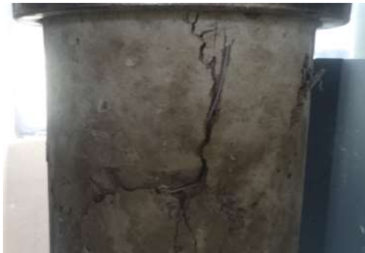
Cosido de Matriz de hormigón con fibra de acero
