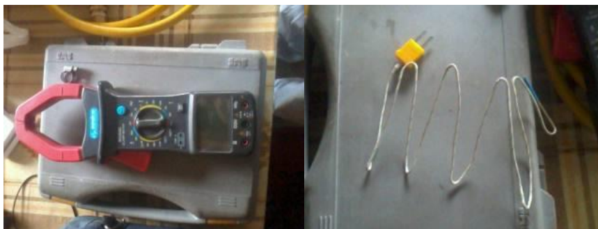
Fig. 3.3. Multímetro con termocupla (utilizado en el proceso). Fuente: Elaborado por Egdo. Oscar Villacís.
