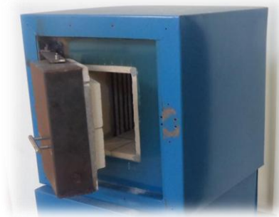
FIGURA 4. Horno Eléctrico por Resistencias, Laboratorio de Materiales FICM-UTA. Fuente: Autor
