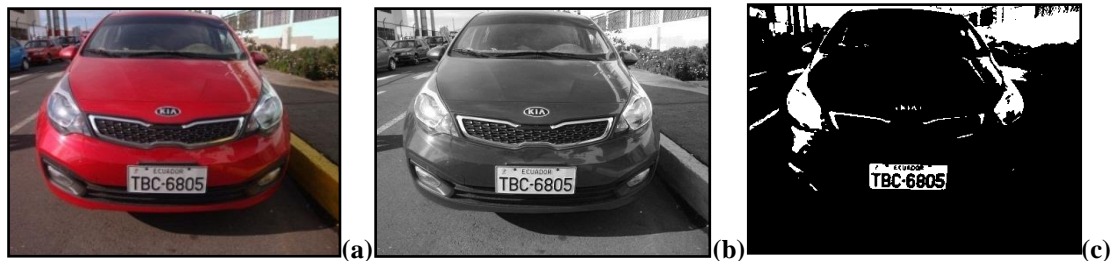
Figura 4.24 (a) Imagen en Color; (b) Imagen en Escala de Grises; (c) Imagen Binaria o Blanco y Negro
