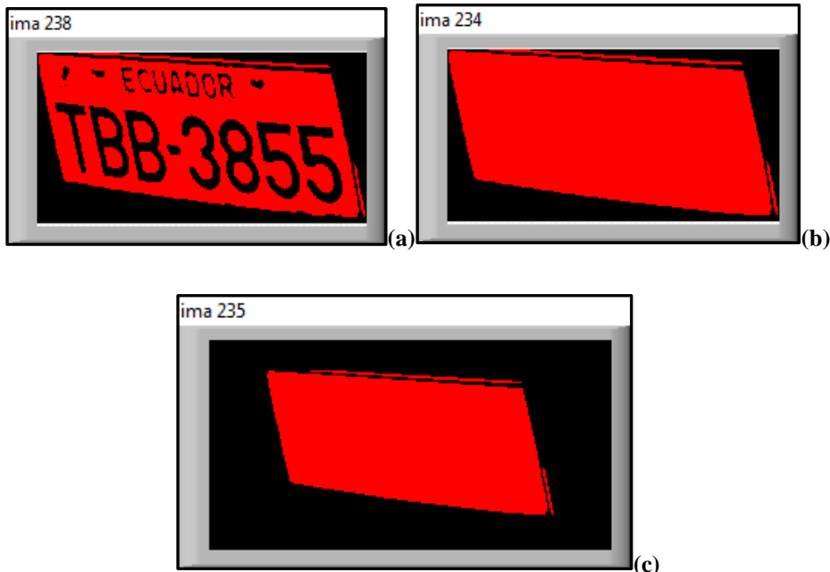
Figura 4.55 Obtención de la forma de la placa (a) Binaria de la placa antes del Hull, (b) Binaria de la placa después del Hull, (c) Binaria de la placa con el marco extendido Elaborado por: El Investigador
