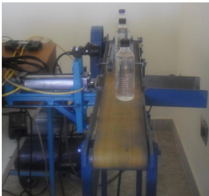
Figura 86. Ingreso de botellas al sistema de visión artificial
