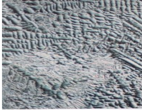
Figura 4.9 Microestructura del latón 65/35, técnica de interferometría de Nomarski, 200x.
