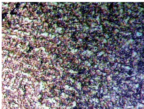
Figura 4.8 Bronce Fosfórico SAE 65, Designación C 90-700, atacado químicamente con Químico para Aleaciones de Cobre durante 13 segundos (zoom 200x)
