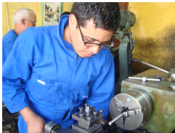
Figura 6.17 Mecanizado de las probetas para el Ensayo de Desgaste Adhesivo
