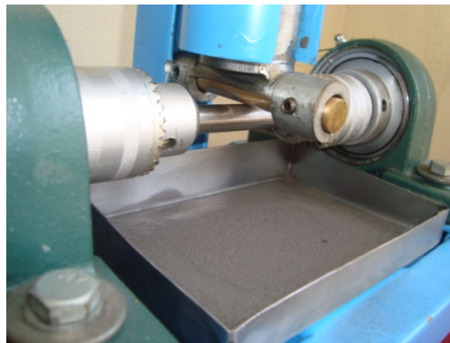
Figura 6.31 Verificación del ángulo entre probetas
