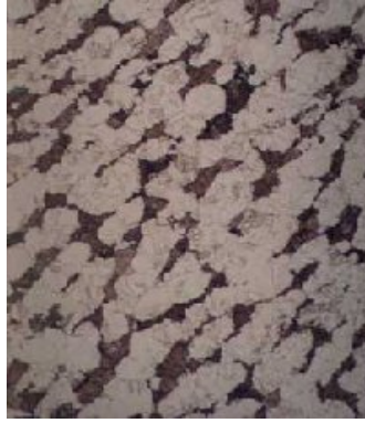
Figura 4.6 Microestructura del bronce Dulce, campo claro. Ataque con dicromato, 200x.
