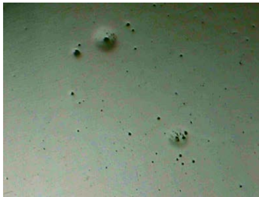
Figura 4.1 Acero AISI 4340 sin ataque químico (zoom 200x)
