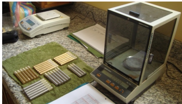
Figura 6.33 Obtención de las masas finales de cada una de las probetas luego del ensayo.
