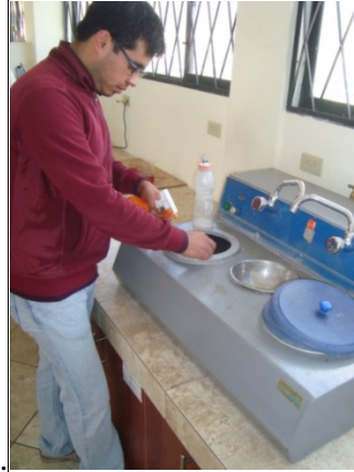
Figura 6.11 Pulido de las probetas para el Ensayo de Dureza
