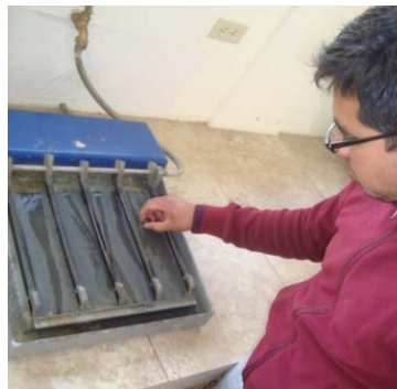
Figura 6.3 Lijado de las probetas para el Ensayo Metalográfico
