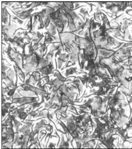
Figura 6 - Microestructura típica en el núcleo (VERSA-BAR FC-200)
