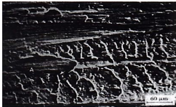
Figura 2.8 Micrografía que muestra el daño dominante por fractura típica de Desgaste Adhesivo Severo.
