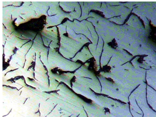
Figura 4.13 Hierro Gris 2P , ASTM A48 CLASE 35-40 ,sin ataque químico (zoom 200x)
