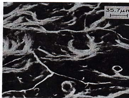
Figura 2.13 Aluminio expuesto a cavitación vibratoria durante 40 seg.
