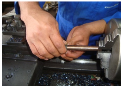
Figura 6.20 Pulido de las probetas para el Ensayo de Desgaste Adhesivo
