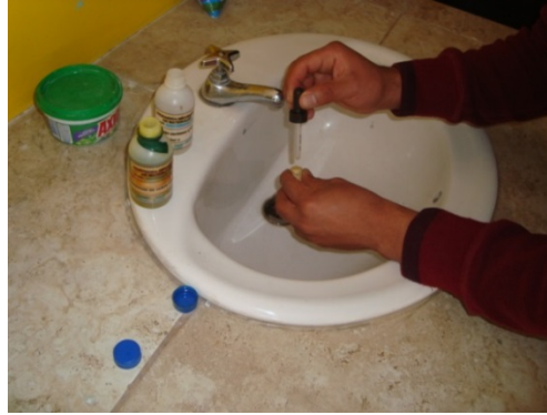
Figura 6.8 Aplicación del Químico empleado en el Ensayo Metalográfico
