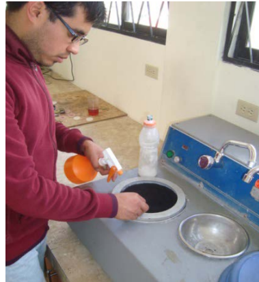
Figura 6.4 Pulido de la superficie de las probetas para el Ensayo Metalográfico
