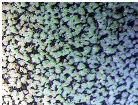
Figura 4.5 Bronce Dulce (Latón), Designación-500, Atacado químicamente con Químico para Aleaciones de Cobre durante 13 segundos (zoom 200x)
