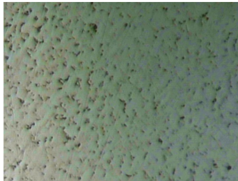
Figura 4.4 Bronce Dulce (Latón), Designación C 38-500, Sin ataque químico (zoom 200x)
