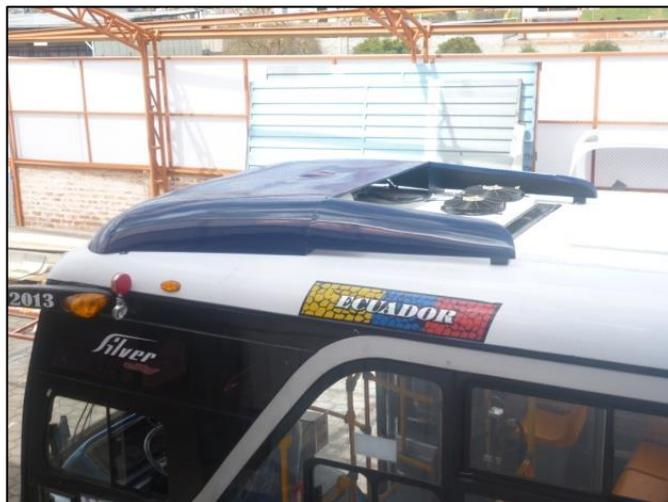
**Foto 6.12. Protección completa de sistema de A/C sobre techo**
