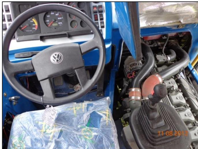
**Fotografía 2.2. Ubicación de Turbo Motor de chasis Volkswagen 17210-OD**
