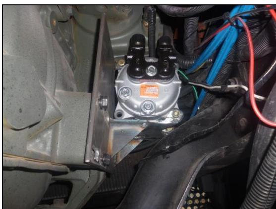
**Foto 6.3. Montaje de compresor sobre base y chasis**
