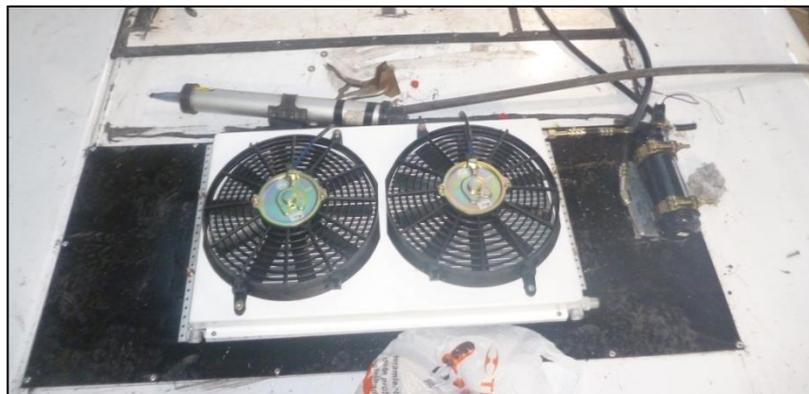
**Foto 6.7. Evaporador ensamblado**
