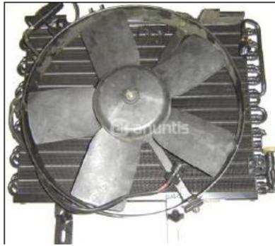
**Figura 6.13. Electro-ventilador**
