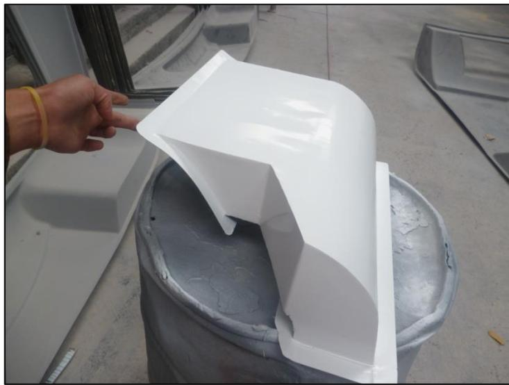
**Foto 6.1. Ducto de succión del evaporador**
