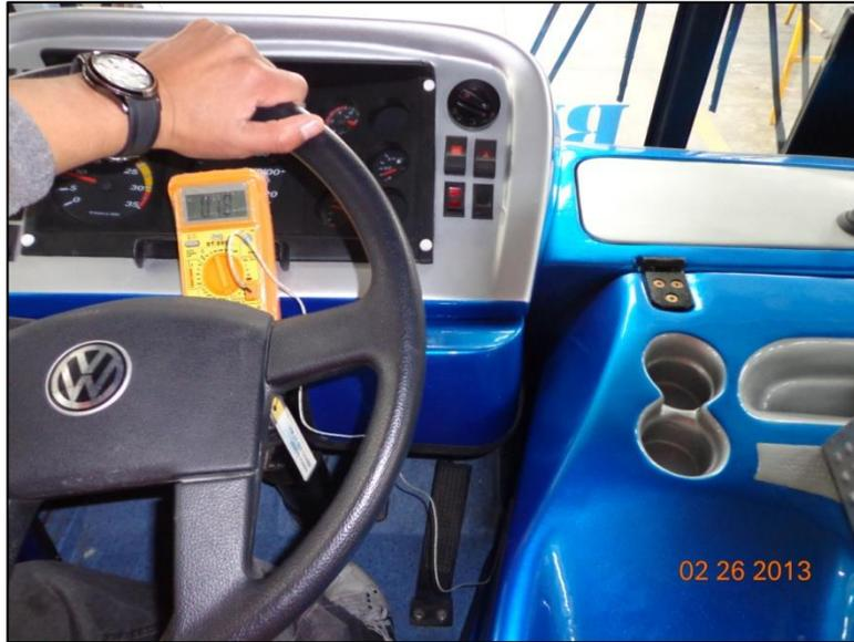
**Fotografía 4.5. Medición temperatura ambiente a la altura del turbo de motor**
