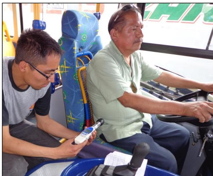
**Foto 6.14. Toma de medidas de °T WGTB con sistema de A/C implementado**
