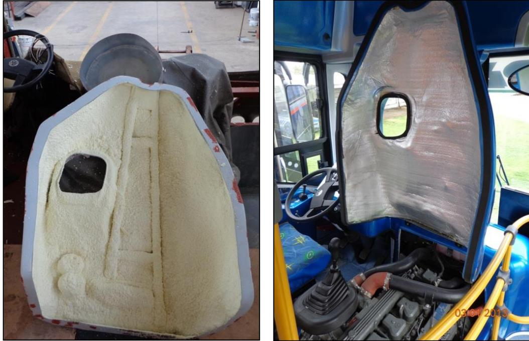
**Fotografía 4.7. Mejoramiento del aislante térmico en tapa máquina**
