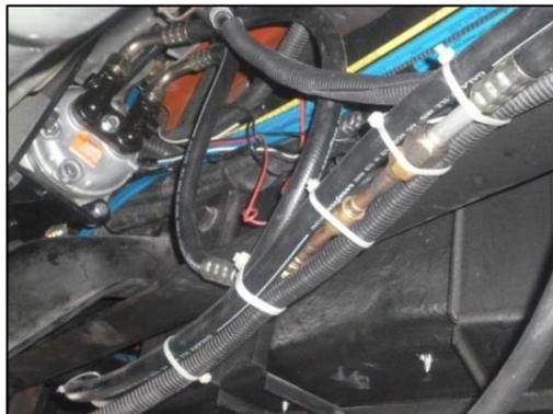
**Foto 6.9. Sujeción de mangueras por debajo de chasis**
