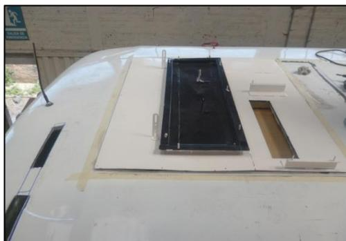
**Foto 6.5. Base soporte de Evaporador sobre techo de autobús**
