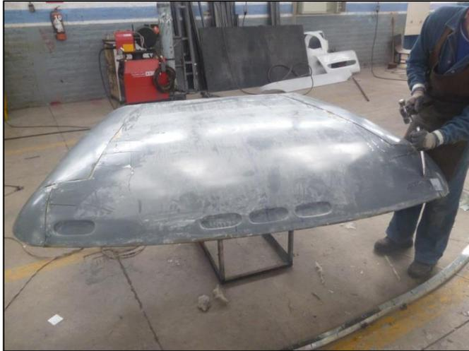
**Foto 6.11. Tapa protectora del sistema de A/C sobre techo de autobús**
