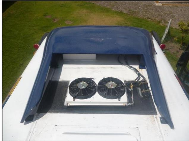
**Foto 6.13. Diseño aerodinámico de protección de sistema de A/C**
