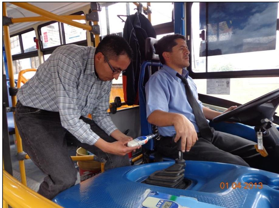
**Fotografía 4.1. Medición de temperatura WGTB, con monitor de estrés térmico**
