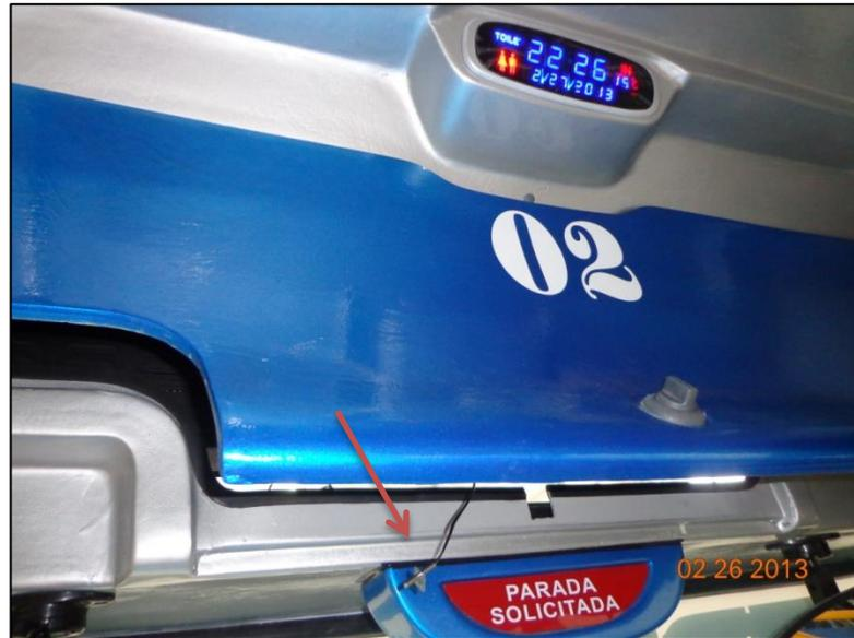
**Fotografía 4.6. Termómetro digital con sensor tipo J, para ambiente interior de vehículo**
