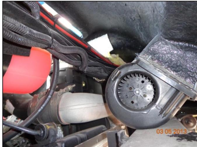
**Fotografía 4.2. Acople de ventilador de aire forzado al tablero del autobús**
