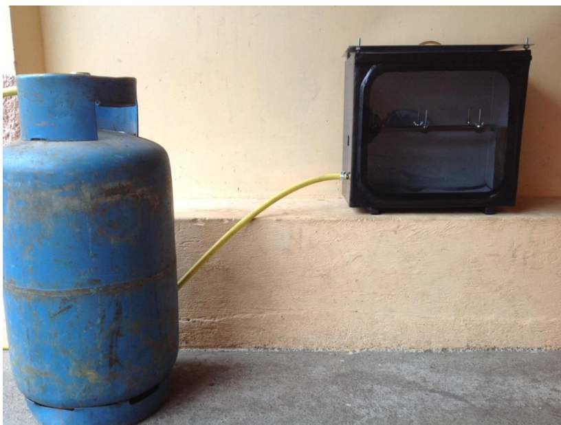
Figura 45. Banco de Pruebas para Ensayo De Inflamabilidad de Materiales
