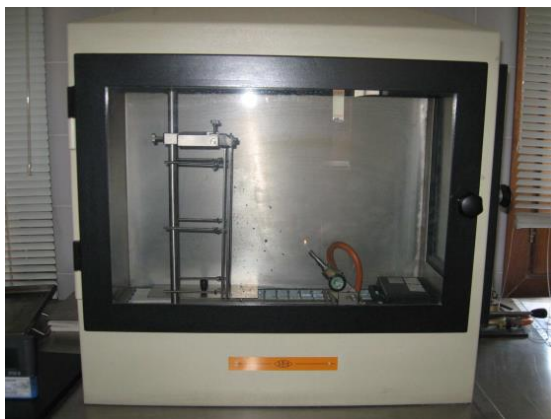
Figura 20. Ensayo De Inflamabilidad (UNE EN ISO 11925-2:2002) (Fuente: http://www.aitex.es/en/ )
