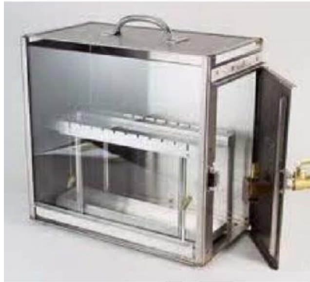
Figura 34. Cámara de combustión con porta muestras y bandeja colectora
