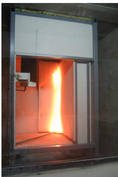
Figura 21. Ensayo De Elemento Individual Ardiendo - SBI (UNE EN 13823:2002) (Fuente: http://www.aitex.es/en/ )
