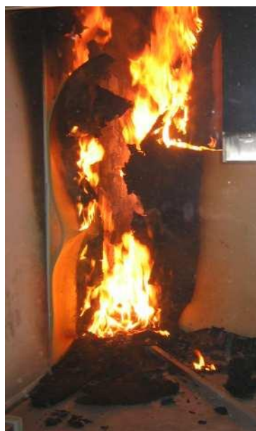
Figura 21. Ensayo De Elemento Individual Ardiendo - SBI (UNE EN 13823:2002) (Fuente: http://www.aitex.es/en/ )
