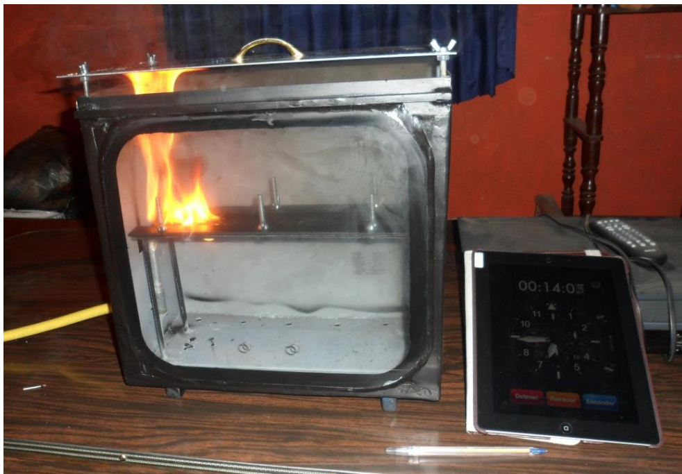
Figura 47. Ensayo de Inflamabilidad para Textil a Base de Vinilo para Piso (Fuente: Realizada por el autor)
