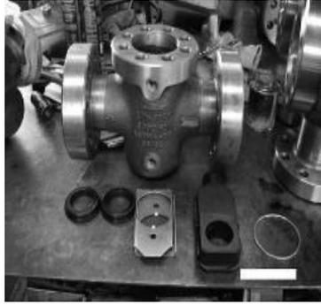
Figura 2 -13: Válvula de compuerta
