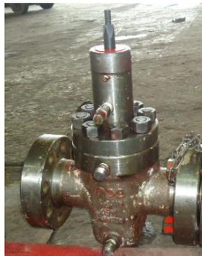
Figura 2 - 1: Válvula de Compuerta Marca NOÉ 2-1/16" 5000 PSI
