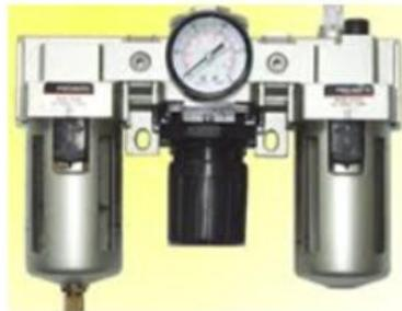
Figura 2 -16: Unidad de mantenimiento para aire
