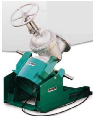
Figura 6 - 1: Banco de pruebas hidrostático
