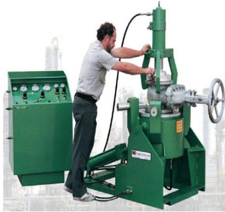
Figura 2 -10: Banco de pruebas Hidrostáticas modelo 1400 API
