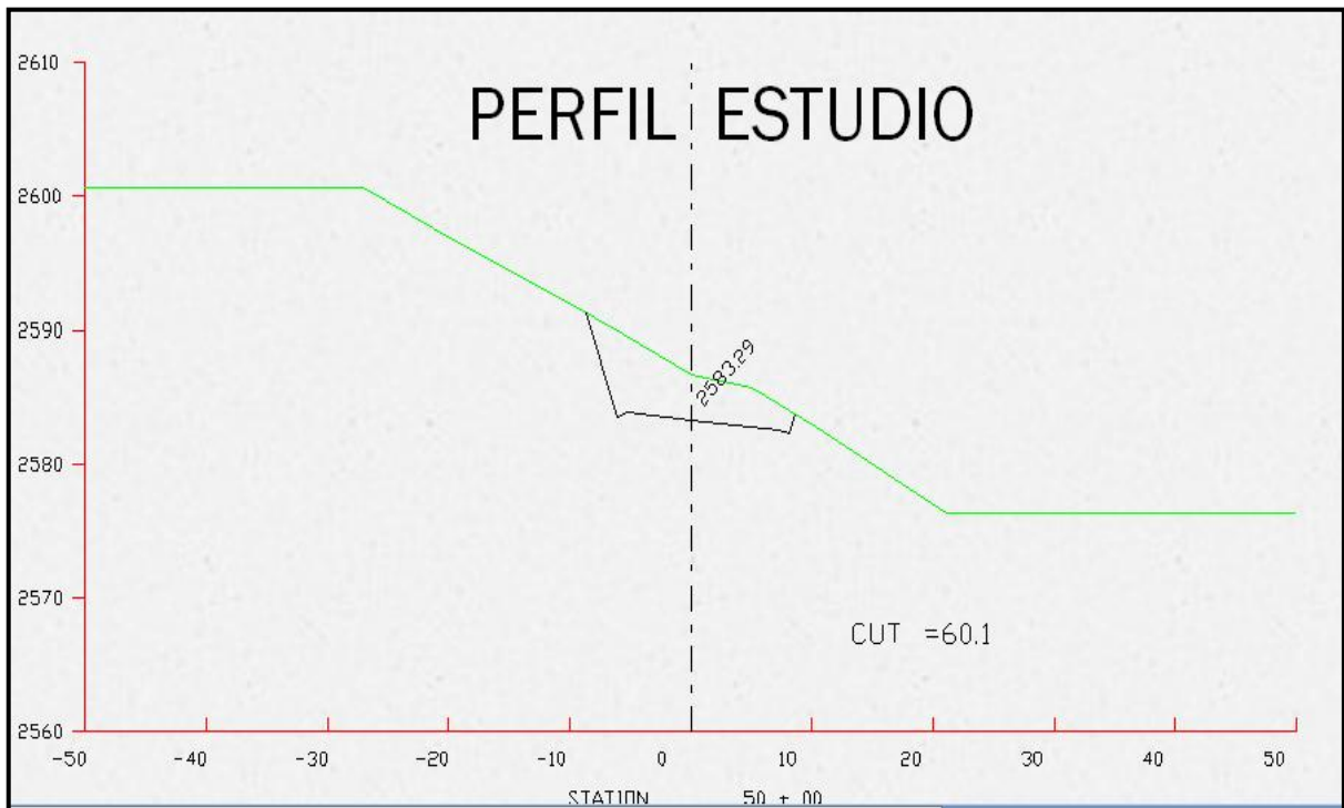
Figura 6.9.9 Sección transversal abscisa 5+000 perfil de estudio. Fuente: Libro de obra compañía Hidalgo & Hidalgo en la construcción de vía Cahujá-Pillate-Cotaló.
