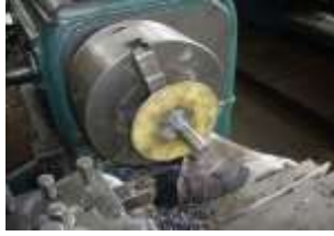
Figura. 6.50 Construcción de la base del molde. Fuente: Francisco Alcocer.
