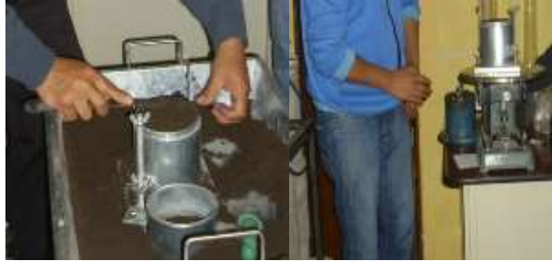
FIGURA 4.5 Peso del suelo compactado
