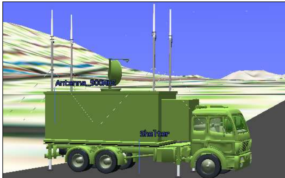
Figura N°. 6.38: Antenas ubicadas en la EMCT diseñada en STK.
