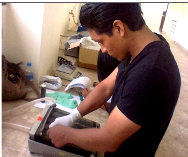
Desbaste de las probetas una vez montadas en baquelita, sobre un banco de lijas, con tres diferentes abrasivos
