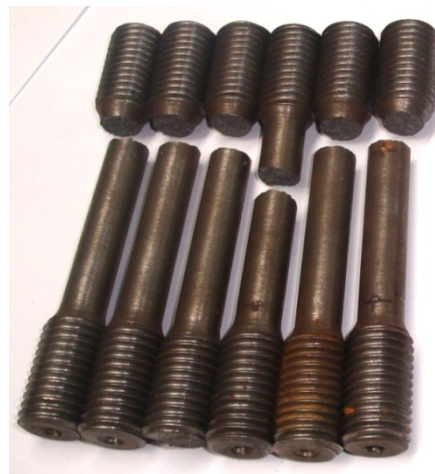
Probetas fracturadas después del ensayo de tracción
