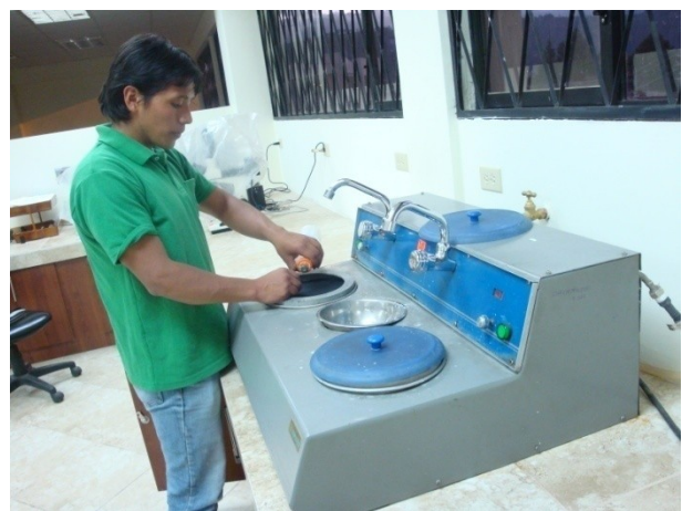
Proceso de desbaste fino de las probetas para el análisis metalográfico en la pulidora de paño, mediante el uso de Alúmina (material abrasivo)
