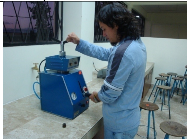
Prensado en baquelita de las muestras para su fácil manipulación en los procesos de desbaste tanto fino como grueso
