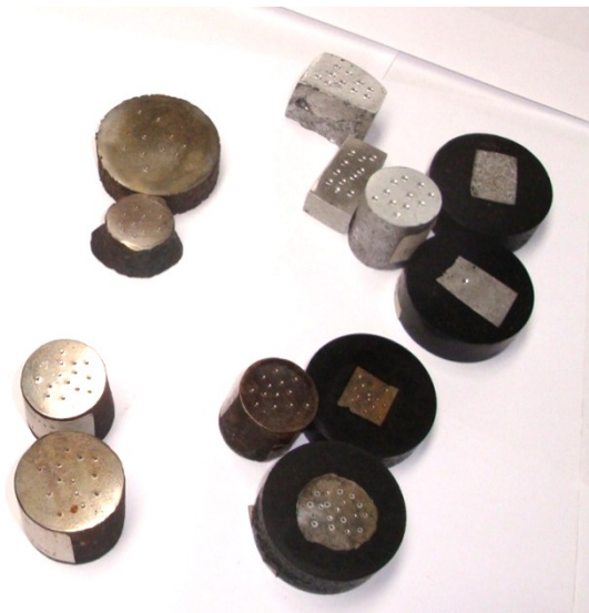
Probetas después de haber sido sometidas al ensayo de dureza
