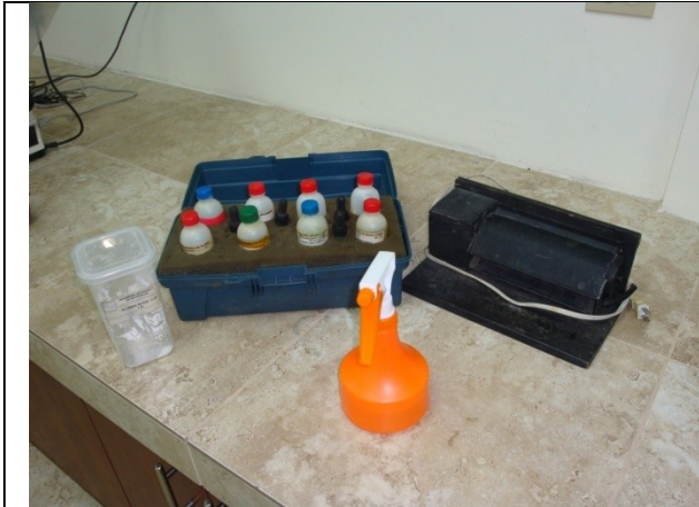
Materiales para el ataque químico en la superficie de las probetas de fundición gris
