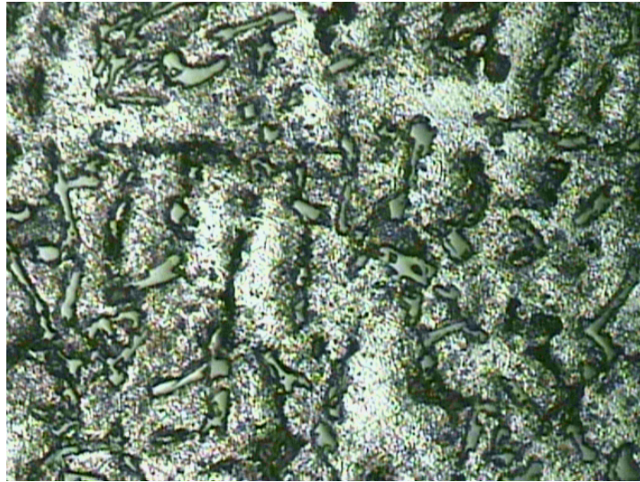
Fig. 12 Microestructura de Aluminio_2 a 100x, atacada con Aleaciones de aluminio, durante 3.21 min
