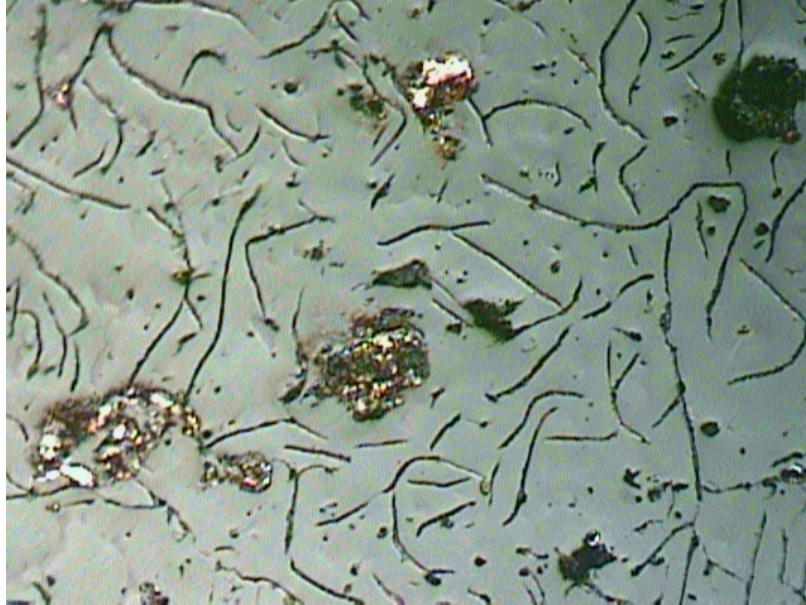
Fig.1 Microestructura fundición gris anterior, a 100X, atacada con Nital 2, durante 3 min
