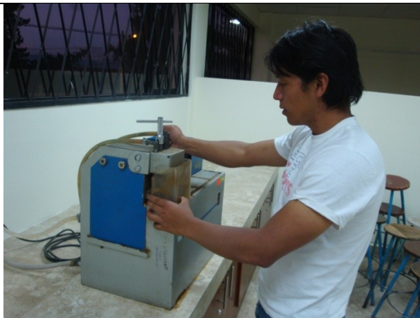
Cortado de las muestras a un tamaño adecuado para el análisis metalográfico
