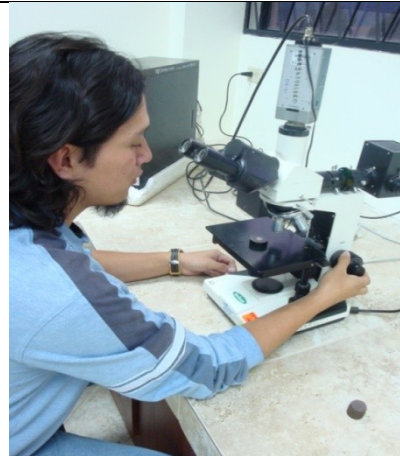
Toma de microfotografías de cada una de las probetas con el microscopio metalográfico, para su posterior análisis
