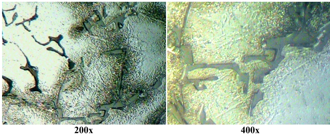
Fig. 15 Microestructura de Aluminio_3, atacada con Aleaciones de aluminio, durante 3.15 min
