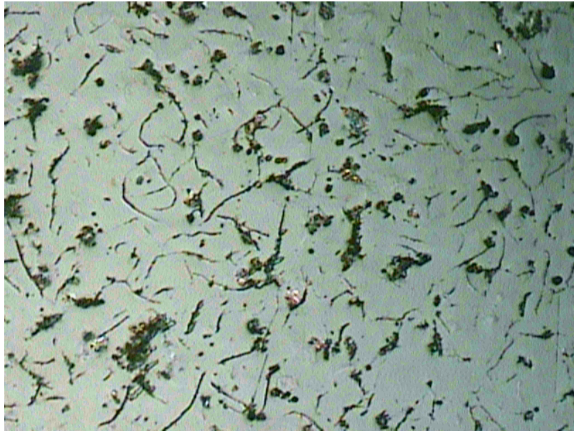
Fig. 5 Microestructura de la fundición gris actual, a 100X, atacada con Nital 2, durante 3 min
