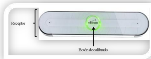
Gráfico N° 33 Partes del receptor – Anexo 2
