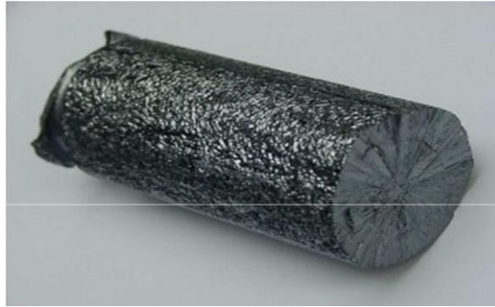
Figura 2.5. Silicio Policristalino - multicristalino
