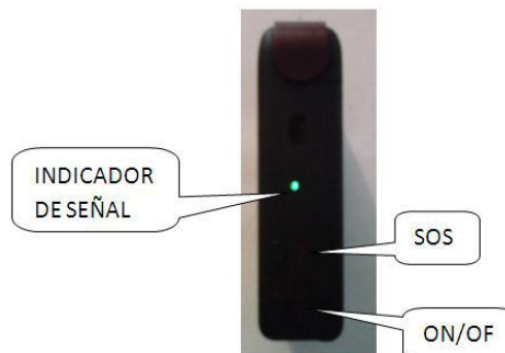
Figura a.2. Vista lateral del GPS Tracker
