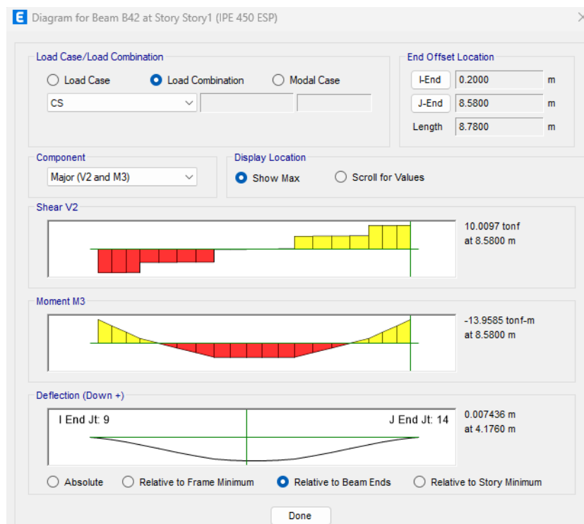
Figura 25. Deflexión obtenida en la viga de 9 m
