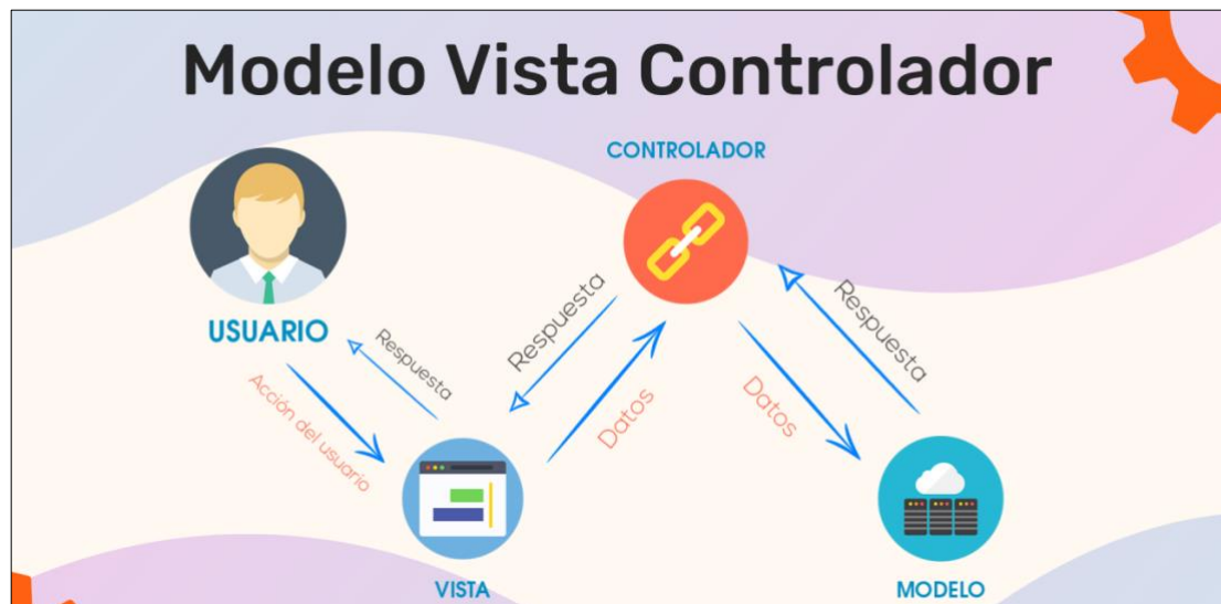
Figura 3.10 Modelo – Vista - Controlador Fuente: [27]
