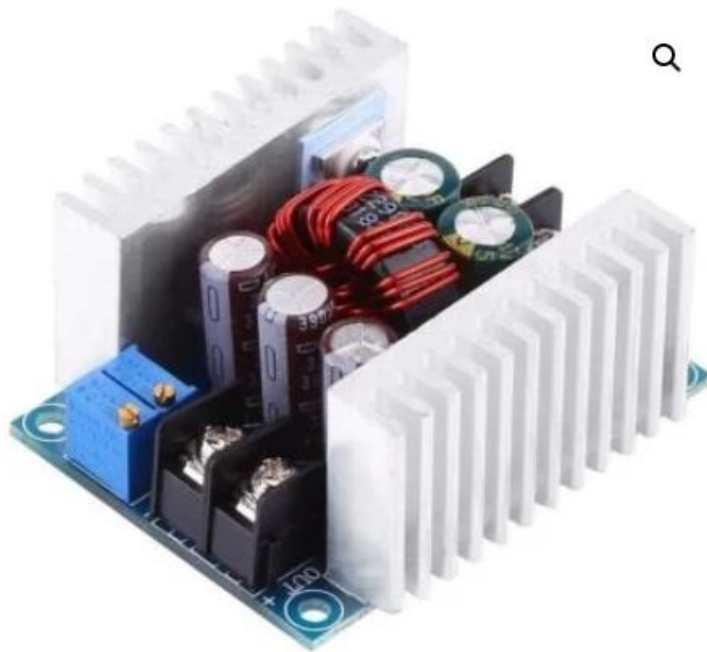
Figura 30. Módulo reductor de voltaje 20A 6V-40V a 1.2V-36V Step Down Buck Ajustable
