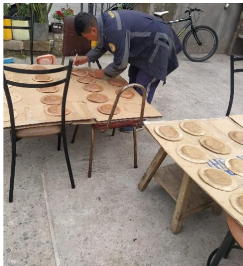
Figura 24.- Segundo recubrimiento del sellador polihidral de grado alimenticio a los platos.
