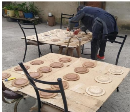
Figura 23.- Aplicación de la película impermeable a los platos.
