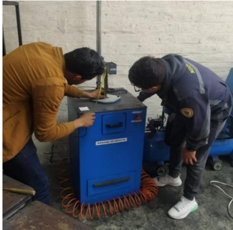
Figura 40.- Cálculo de la altura del dardo (calibración).
