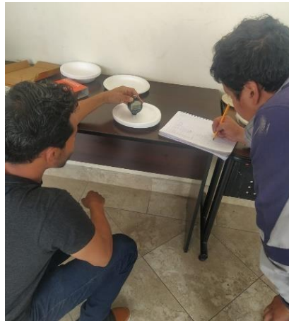
Figura 46.- Toma de medidas con el durómetro en los platos.
