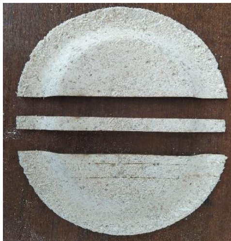
Figura 28.- Probeta cortada con la cortadora laser.
