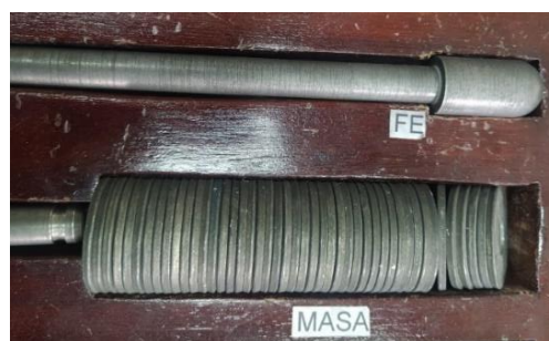
Figura 39.- Dardo FE de 231 gr, y anillos con masa equivalente.
