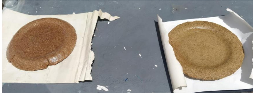
Figura 25.- Aplicación de agua al plato sellado.
