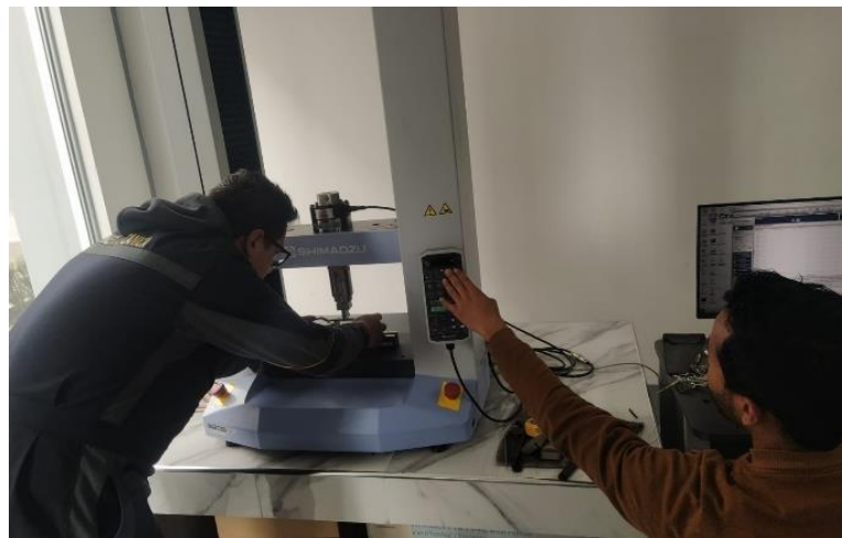
Figura 30.- Colocación de las probetas en la máquina para ensayos de flexión.
