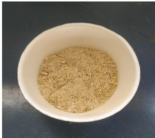
Figura 18.- Bagazo de caña de azúcar molido por segunda vez.
