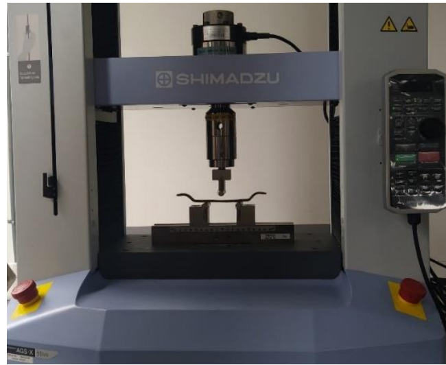
Figura 29.- Máquina para ensayos de tracción y flexión.
