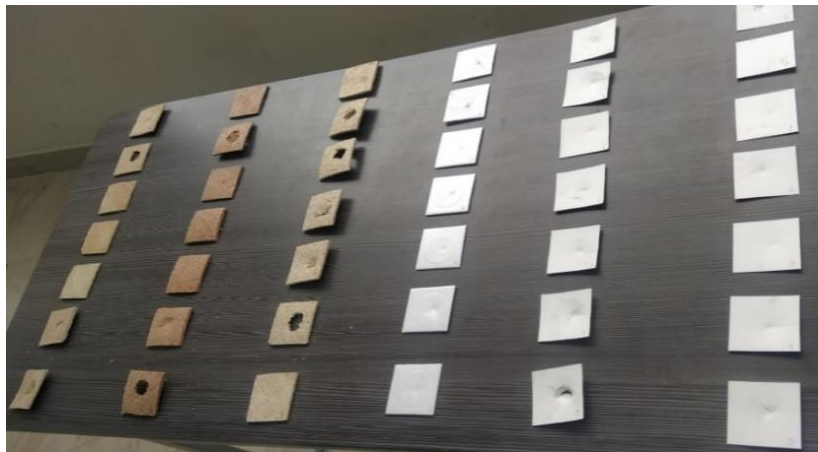
Figura 42.- Probetas sometidas al ensayo de impacto.
