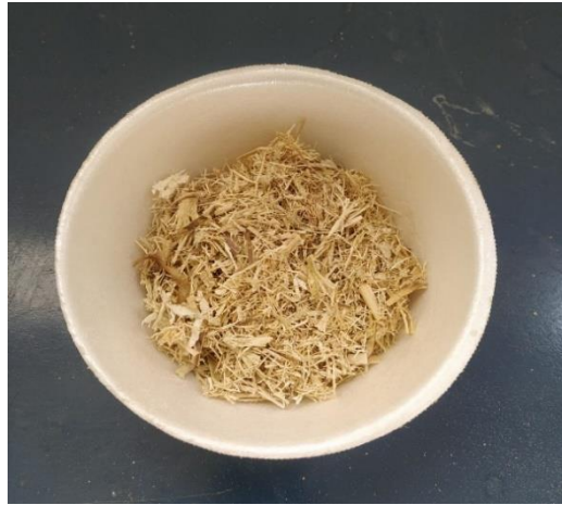
Figura 17.- Bagazo de caña de azúcar molido por primera vez.
