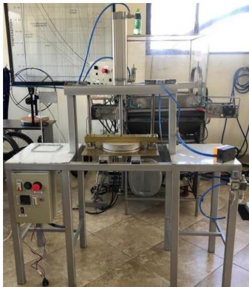
Figura 13.- Prensadora de platos [3].
