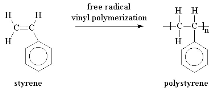
Figura 3.- Estructura del poliestireno [31].
