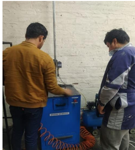
Figura 41.- Accionamiento de la máquina para crear el impacto del dardo con la probeta.
