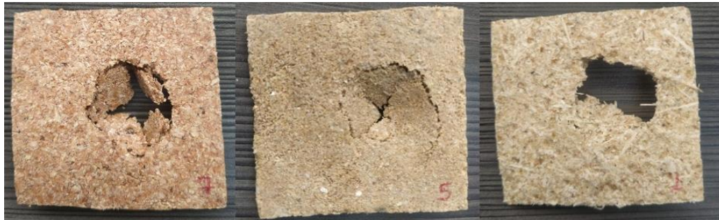
Figura 43.- Comparación de los materiales sin película impermeable.
