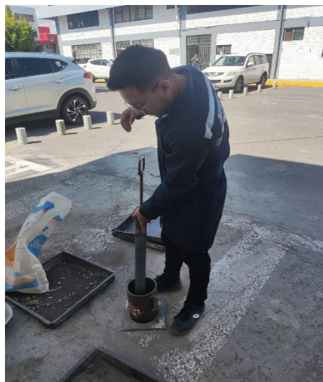
Ilustración 9: Compactación de Proctor modificado tipo B
