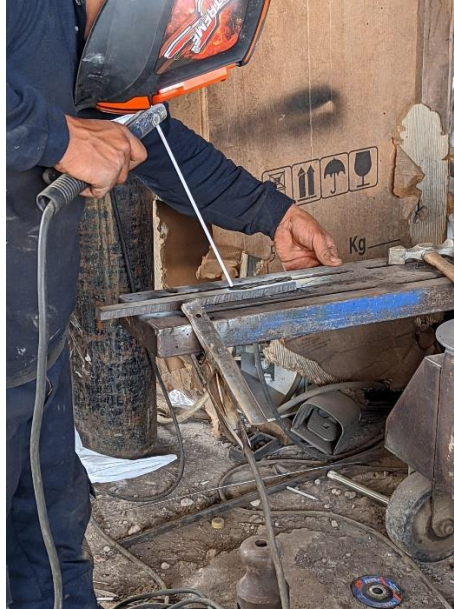
Figura 3 Relleno de soldadura.
