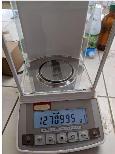
Figura 19 Probeta pesada en balanza de 0,0001g
