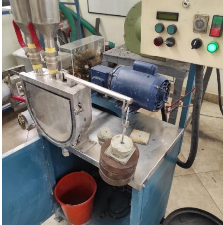
Figura 15 Máquina de desgaste abrasivo en prueba en funcionamiento.
