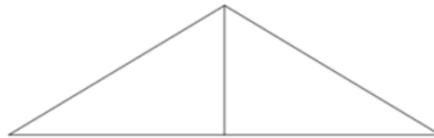
Figura 12.- Armadura tipo “A” Fuente. [15]
