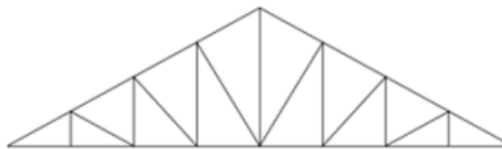
Figura 14.- Armadura tipo Howe Fuente. [15]
