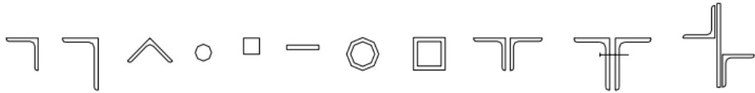
Figura 28.- Construcción soldada para montantes y diagonales Fuente. [16]
