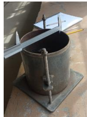
Anexo B18: Realización del ensayo CBR
