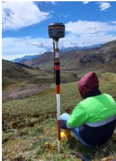
Figura 24. Punto de control marcados con RTK
