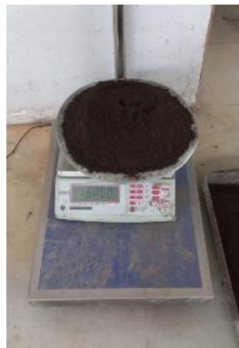
Anexo B17: Realización del ensayo de compactación de suelo
