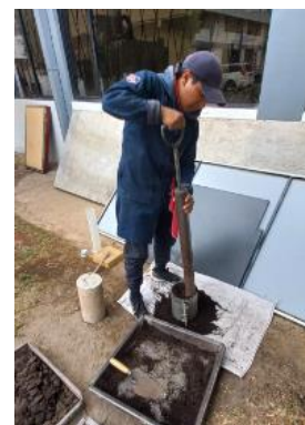
Anexo B20: Introducción de las muestras en cámara sumergible
