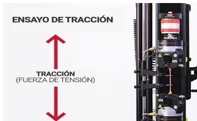
Figura 6. Ensayo de tracción, aplicado para materiales compuestos [21].
