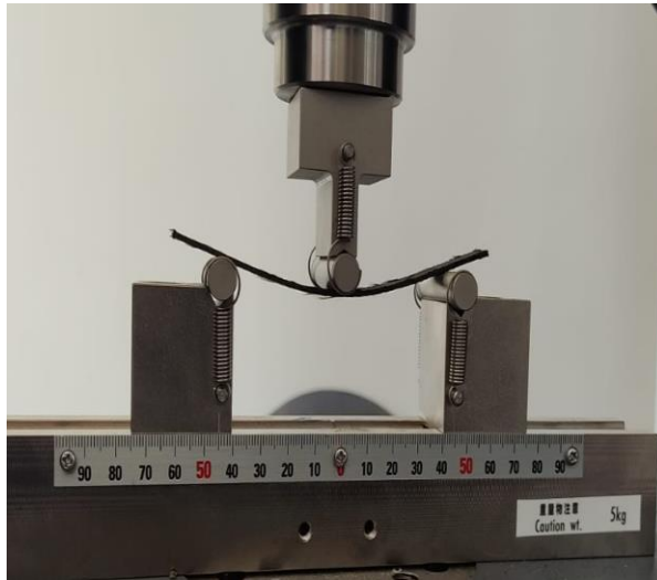
Figura 31. Ensayo de flexión en la máquina de ensayos Universal.
