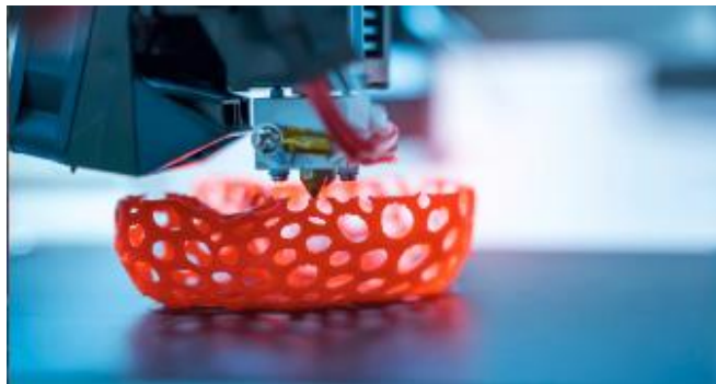
Figura 9. Proceso de impresión en 3D [28].
