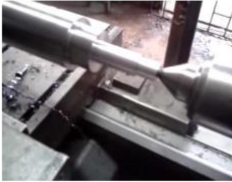
h. Mecanizado de tapas de rodamientos de eje
