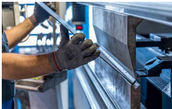
Figura 2. Máquina plegadora hidráulica [8]
