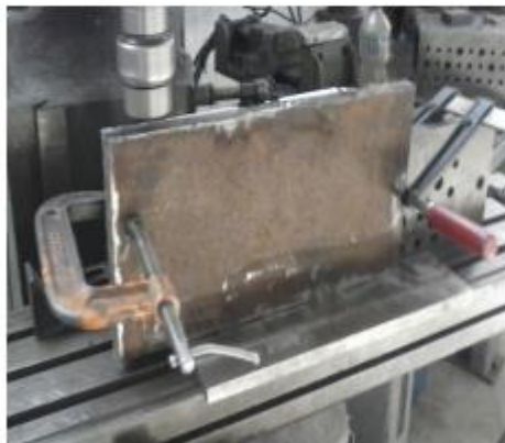
f. Perforado en placas de unión al actuador
