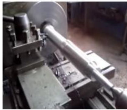
i. Mecanizado de eje perforado
