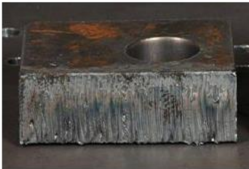
j. Mecanizado de base estructura unión reductor
