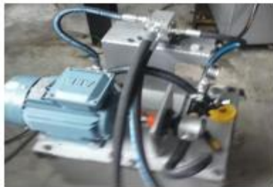
i. Ensamble final del sistema hidráulico
