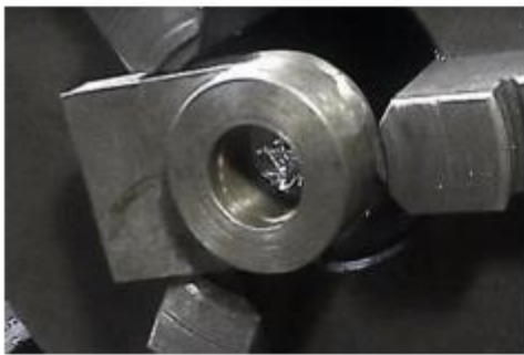
j. Mecanizado de base estructura unión reductor
