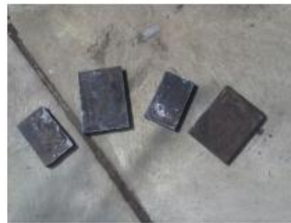
e. Corte de placas de unión del actuador
