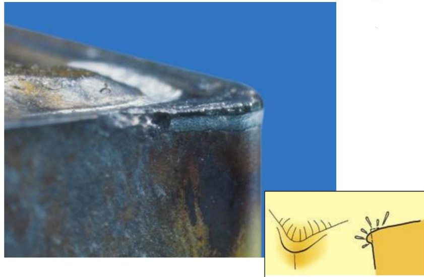
Figura 28. Desgaste por deformación plástica [33].
