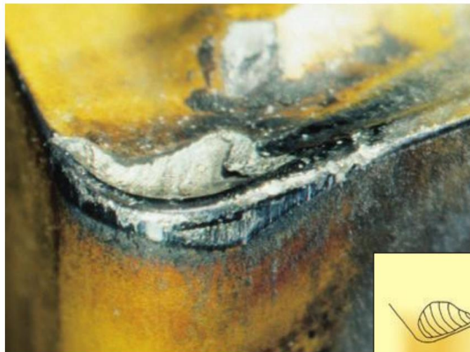
Figura 27. Desgaste de cráter [33].
