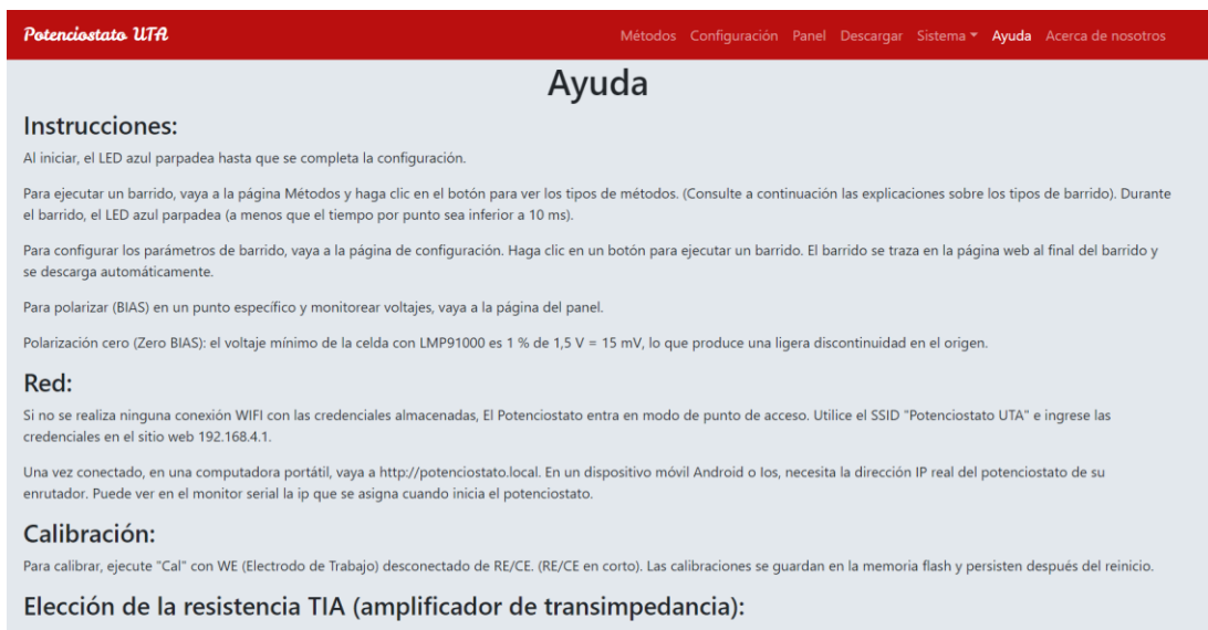
Figura 38. Sección de Ayuda para la operación del potenciostato
