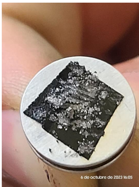
Figura A36. Muestra del electrodo de Quitina/GO para ingresar a ser analizada por el SEM.
