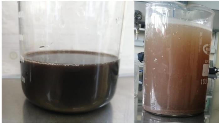
La imagen de la izquierda indica el efluente del agua sin tratar con un color marrón oscuro, lo cual indica una alta concentración de materia. Sin embargo, la imagen de la derecha se observa un cambio en el color, ya que existió una disminución significativa en los contaminantes teniendo una muestra de agua más clara y presenta unos pequeños coágulos que se están precipitando.
