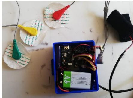
Figura 29. Circuito integrado en el case
