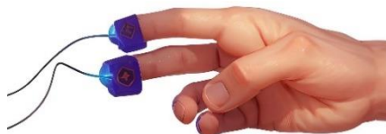
Figura 21. Colocación de los electrodos para GSR[57]
