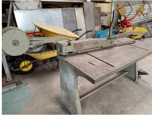
Figura 13. Cortadora de láminas metálicas
