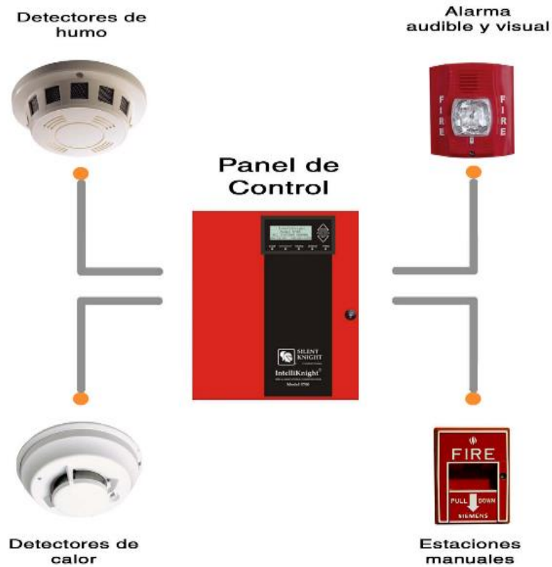
Figura 9. Sistema de alarma contra incendios
