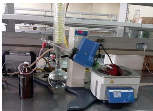
**Anexo 9.** Realización del método gravimétrico para la obtención de sólidos totales.
