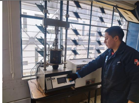
12- Colocación de las muestras en la máquina de compresión para determinar la curva de deformación
