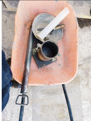
10- Equipos utilizados para la elaboración del ensayo de CBR
