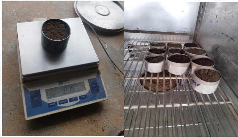
Figura 6. Ensayo de contenido de humedad de suelo
