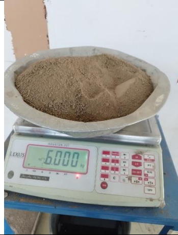
8- Pesaje del suelo para elaboración del ensayo Proctor modificado
