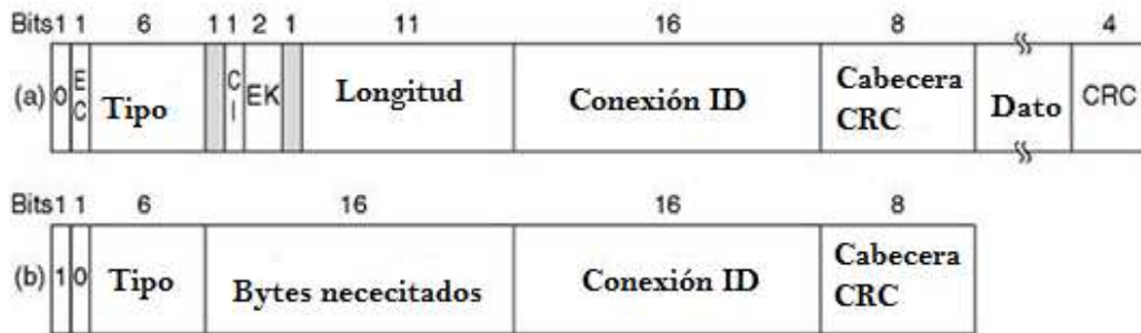
Figura 2.23 a) Trama genérica b) Trama de solicitud de ancho de banda Obtenida de: http://ariadna.ii.uam.es/wiki/wiki_ar1/lib/exe/fetch.php?media=tema5_dibujo57.jpg
