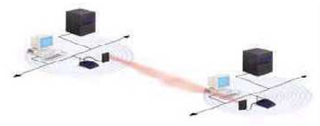
Figura 2.16 Interconexión de LAN mediante antenas direccionales
