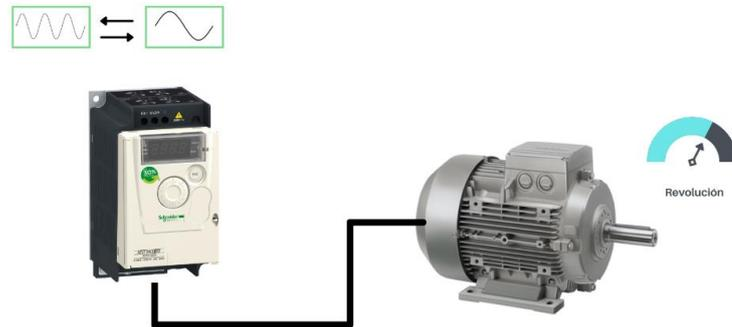
Figura 25. Motor trifásico y variador de velocidad [52].
