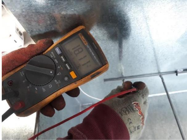
*Figura 61. Medición de voltaje que circula por los electrodos.*
