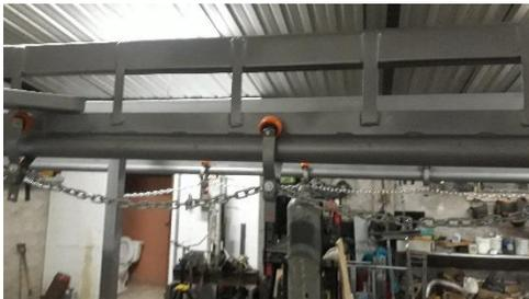
*Figura 64. Sistema de transporte aéreo.*
