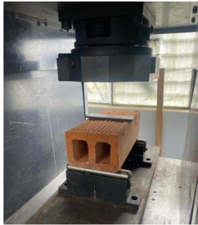
Figura 30: Colocación de ladrillo a ensayar.
