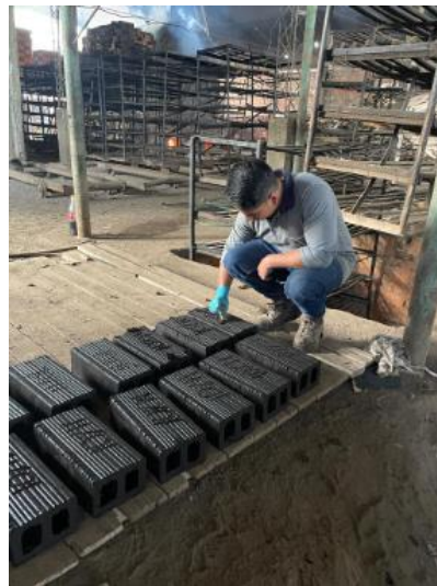
Figura 17: Señalización de ladrillos
