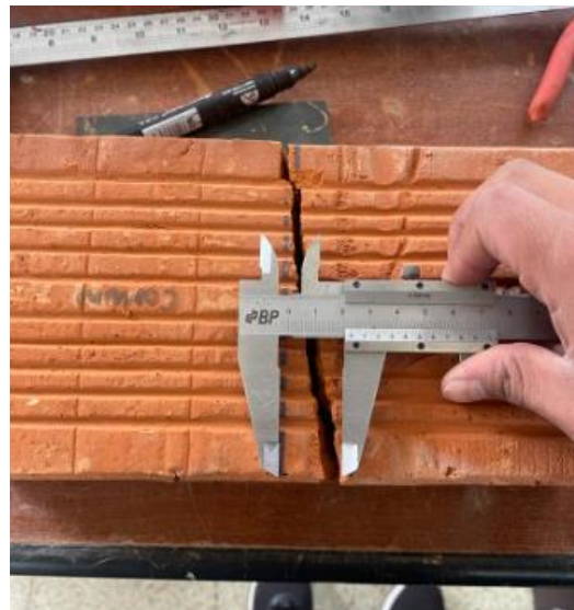
Figura 33: Medición de distancia promedio de falla
