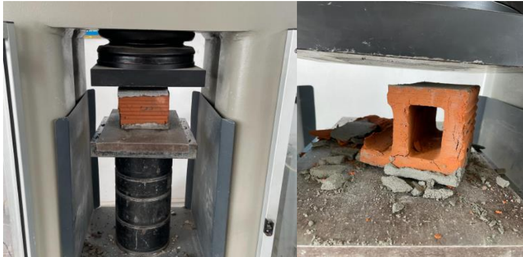
Figura 24: Ensayo resistencia mínima a la compresión
