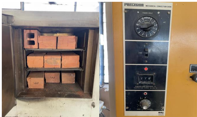
Figura 25: Secado de ladrillo en horno.
