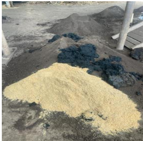
Figura 9: Mezcla de barro, aserrín y fangos
