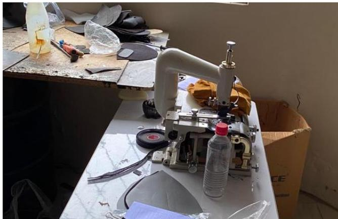
*Nota:* En la ilustración se muestra la máquina que interviene en el desgaste del cuero previo al inicio del coser de piezas.
