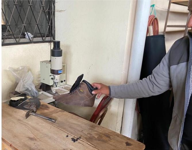
*Nota:* En la ilustración se encuentra el área y la máquina que interviene en la colocación de ganchos metálicos en el calzado.
