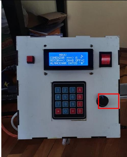
Una vez encendido el aire se procede a empezar con la toma de datos presionando el botón A.
