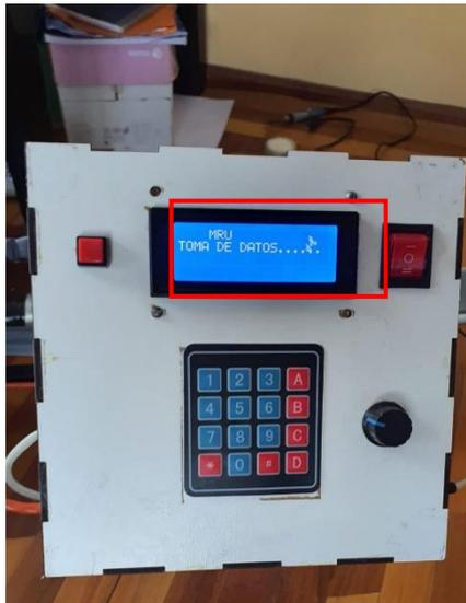
Finalizada la toma de datos se muestran los resultados en la pantalla, tanto para tiempo como para velocidad, para cambiar la pantalla de datos se presiona el botón “\*”.
