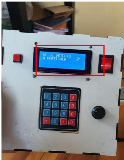
La activación del sensor se verifica mediante el encendido de una luz de color rojo.
