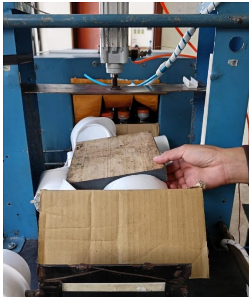
Figura 2.2.- Colocación de los desechos en el sistema de compactación
