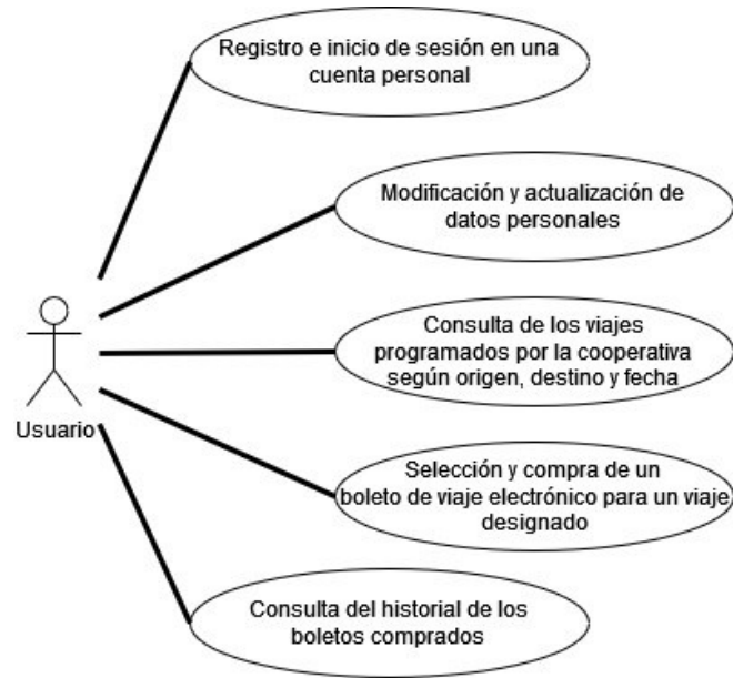
Figura 18. Diagrama de caso de uso de un usuario
