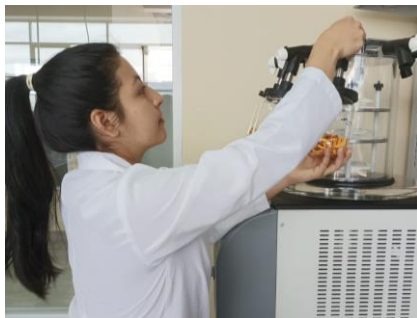
Figura 10. Ingreso de muestras de chontaduro en el liofilizador
