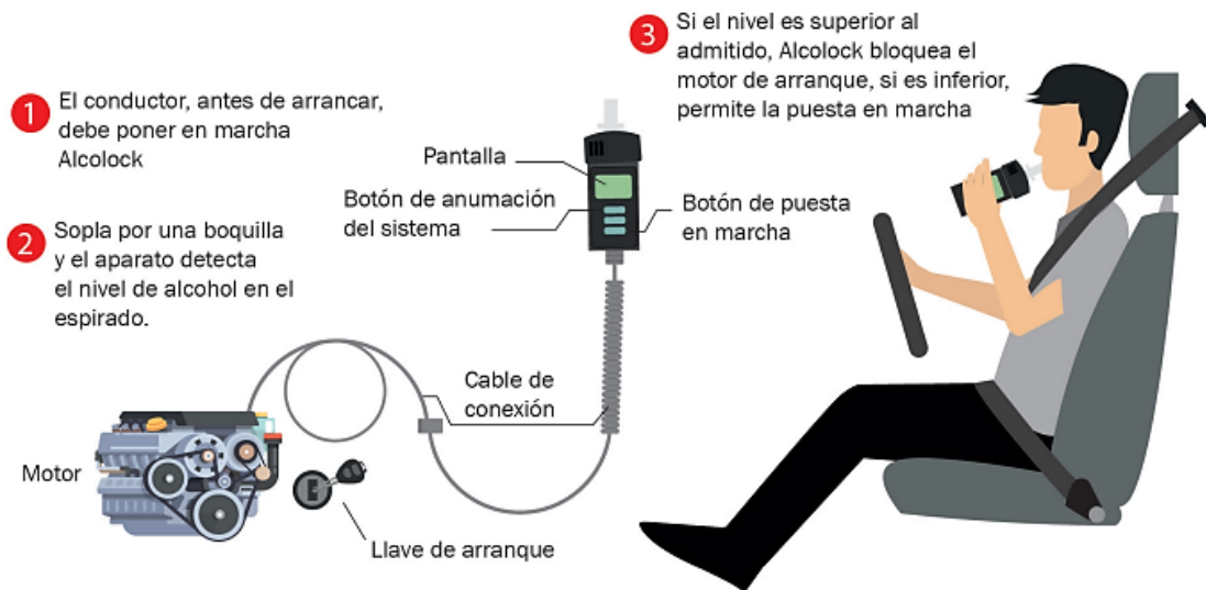
Figura 9. Funcionamiento del sistema alcolock [25].
