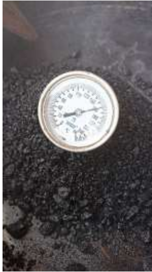
Figura 14: Mezcla de asfalto a 160° C
