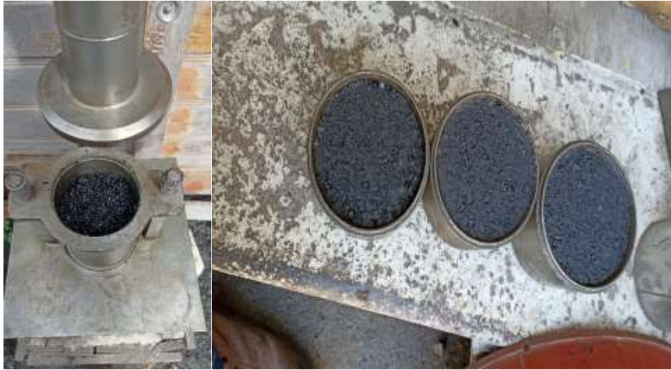
Figura 6: Compactación de briquetas
