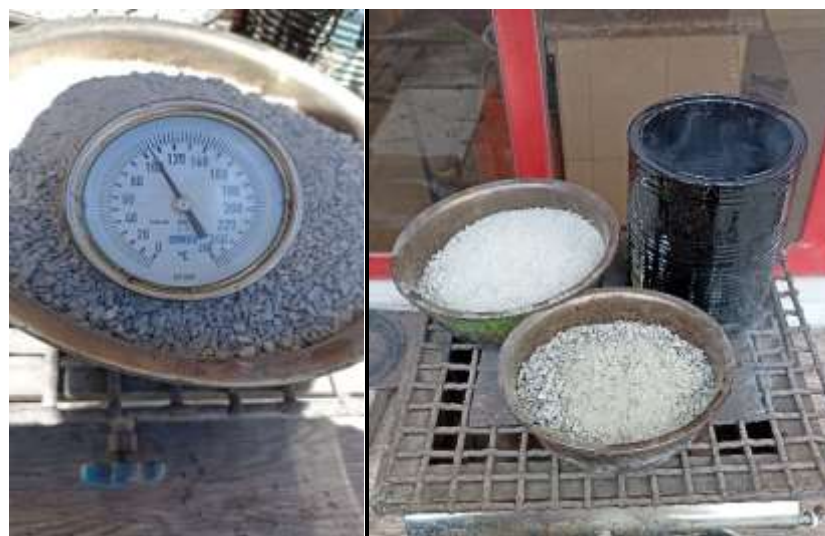
Figura 2: Calentado de los agregados y AC-20
