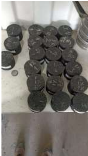
Figura 7: Extracción de briquetas
