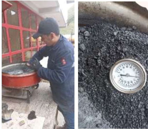
Figura 4: Mezclado de la muestra patrón
