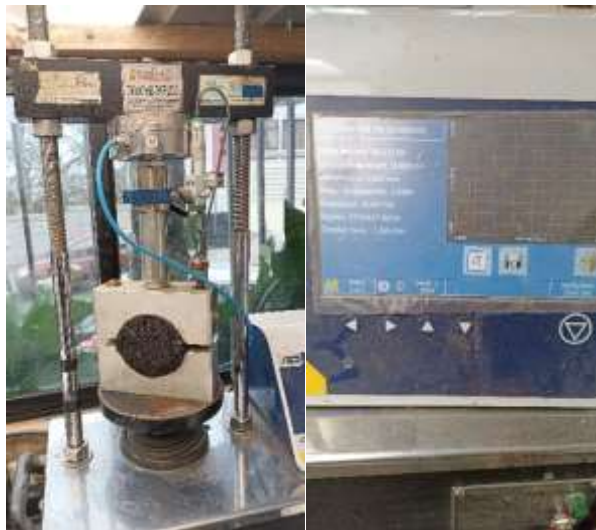
Figura 17: Ensayo de estabilidad y flujo
