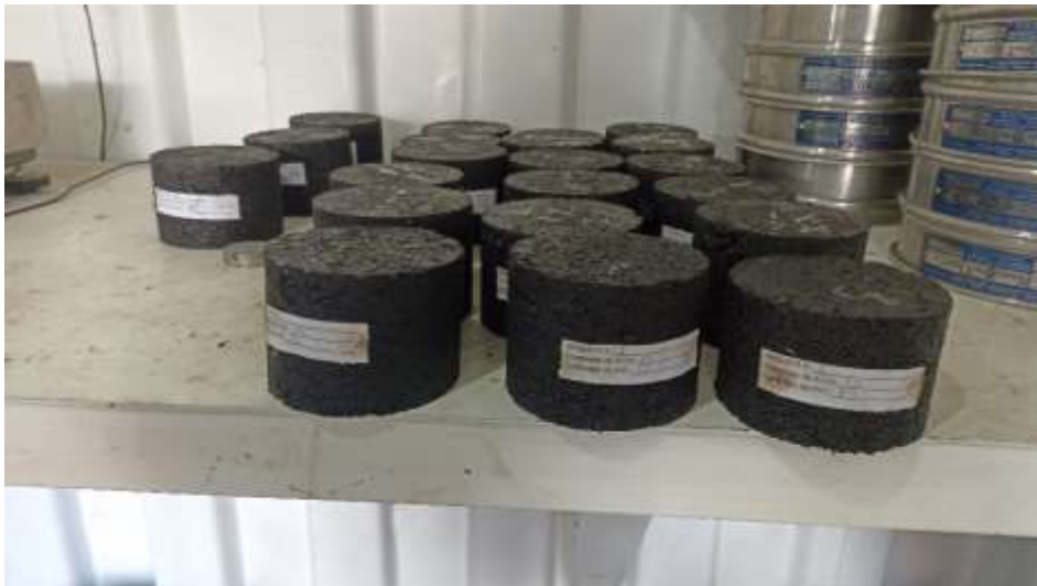
Figura 15: Briquetas con PVC
