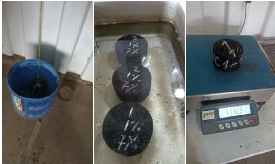
Figura 8: Pesos de las briquetas en el aire, sumergida y saturada
