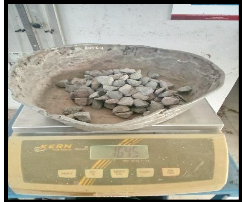
Fotografía 8: Toma de pesos retenidos en los tamices de agregados gruesos
