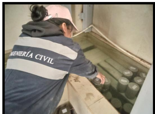
Fotografía 30: Colocación de probetas en la cámara de curado.
