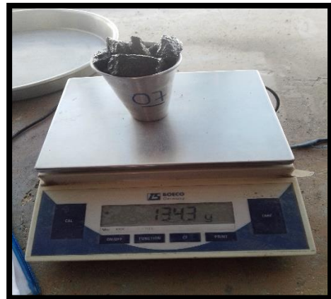
Fotografía 16: Toma de muestras para capacidad de absorción del ripio.
