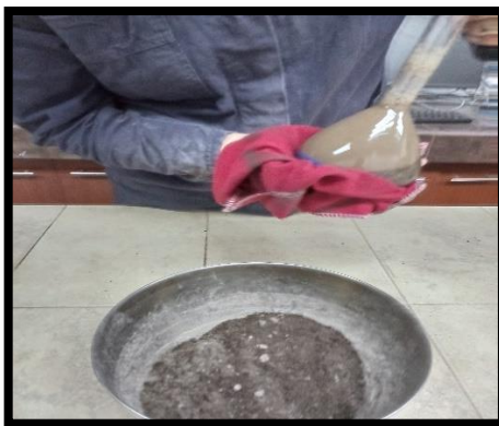
Fotografía 9: Muestra (SSS) agregado fino
