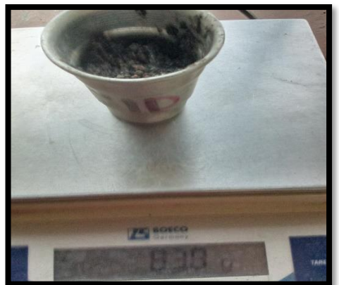
Fotografía 10: Toma de masas picnómetro + muestra(SSS) + agua
