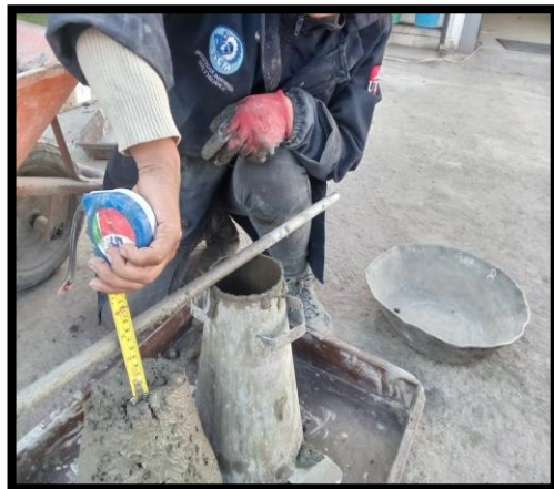
Fotografía 28: Ensayo para medir el asentamiento de la mezcla.
