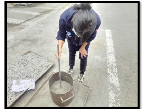
Fotografía 22: Densidad compacta del agregado fino
