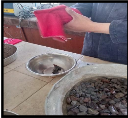
Fotografía 13: Muestra (SSS) agregado grueso.
