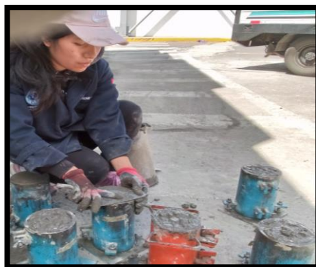
Fotografía 29: Colocación de hormigón en moldes metálicos.
