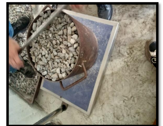
Fotografía 24: Densidad aparente compacta del agregado grueso
