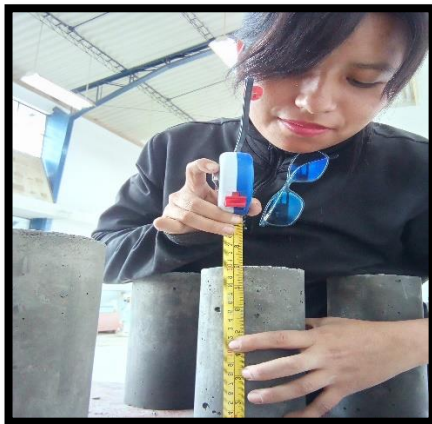
Fotografía 31: Medición de altura de las probetas.
