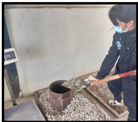
Fotografía 23: Densidad aparente suelta del agregado grueso
