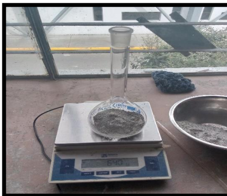
Fotografía 17: Peso del picnómetro + cemento
