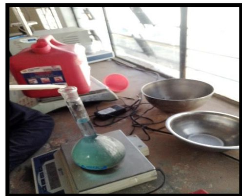
Fotografía 18: Peso del picnómetro + cemento + gasolina
