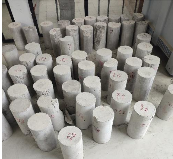
Figura 2. Probetas de hormigón para ser trituradas Fuente: Joseph Henry Sánchez Freire
