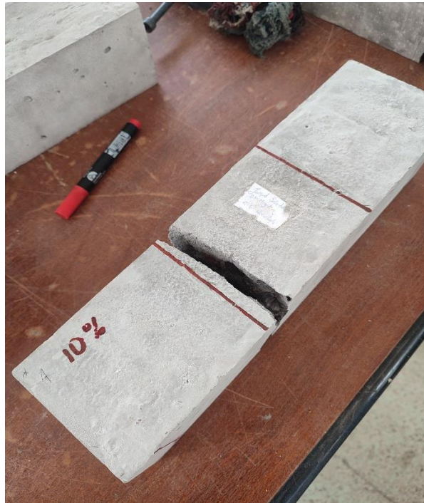
Figura 18. Tipo de falla en las vigas. Fuente: Joseph Henry Sánchez Freire
