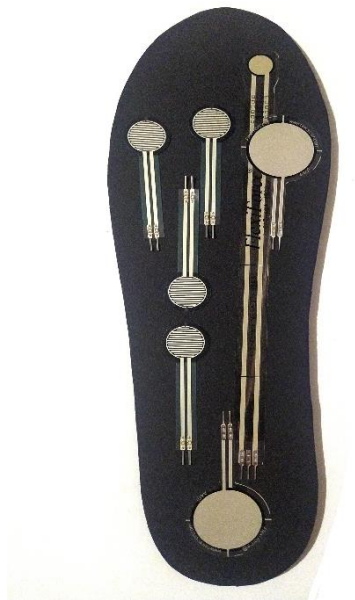
Figura 35. Colocación de los sensores en la plantilla. Elaborado por: La investigadora.
