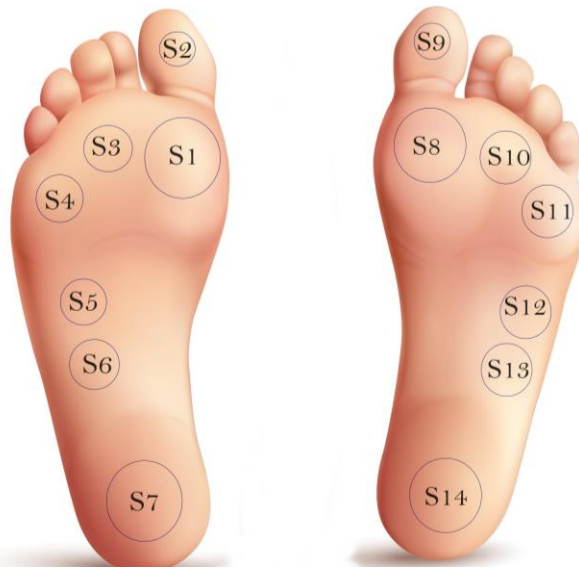
Figura 33. Ubicación y distribución de los sensores por zonas del pie. Elaborado por: La Investigadora.
