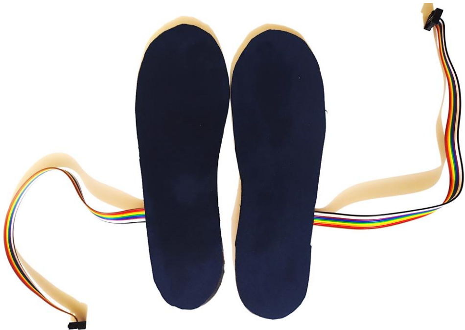
Figura 37. Plantillas con una tela de protección. Elaborado por: La Investigadora
