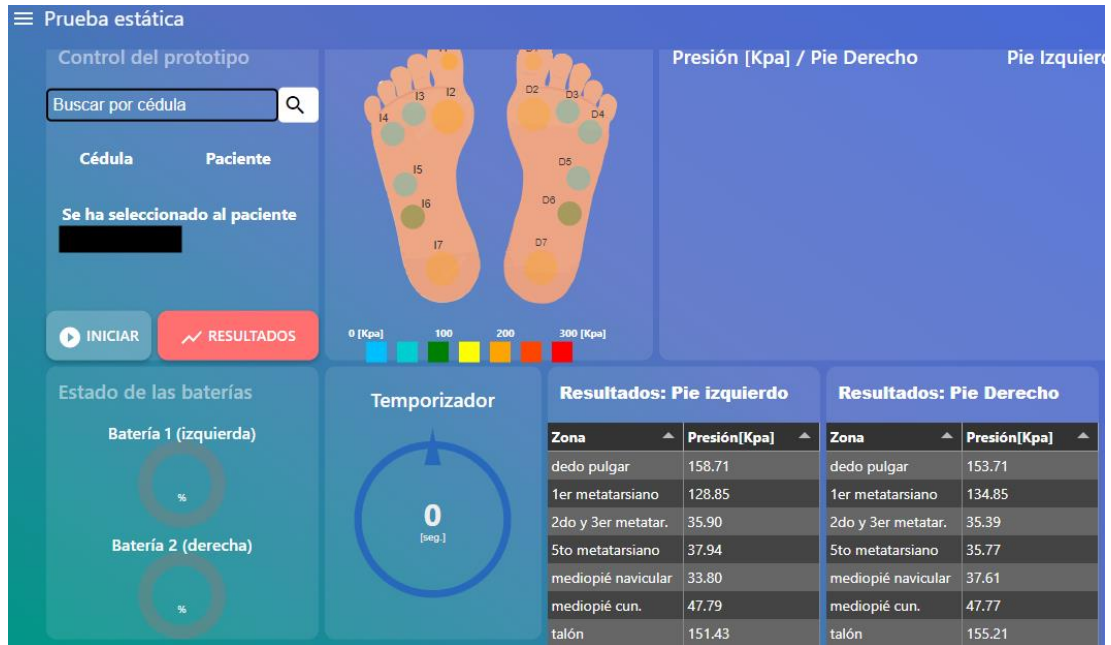
Figura 61. Prueba de apoyo estático sujeto 1 Node-RED Dashboard. Elaborado por: La Investigadora
