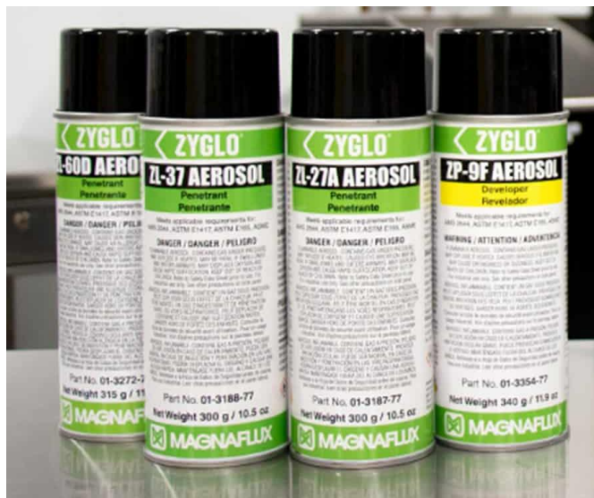
Figura 1-13: Kit de tintas penetrantes fluorescentes. [31].
