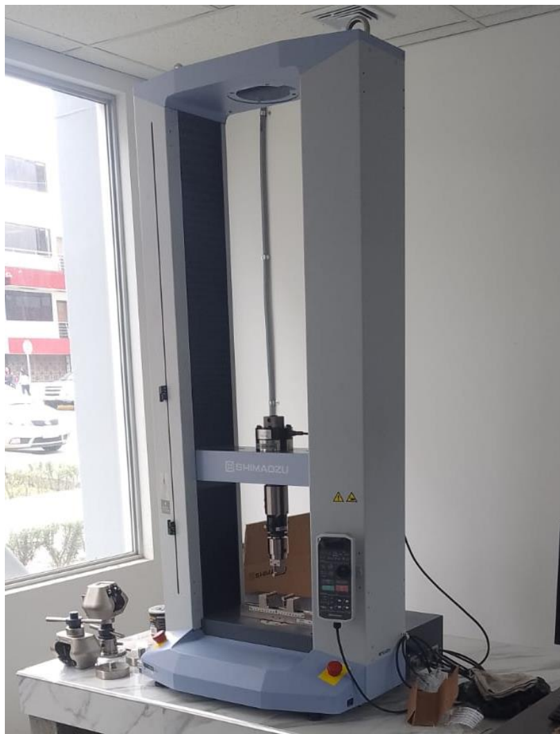
Figura 3 Máquina universal de ensayos a tracción de la Universidad Técnica de Ambato
