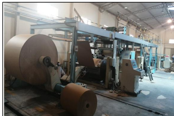
Figura 10. Proceso de corte y corrugado
